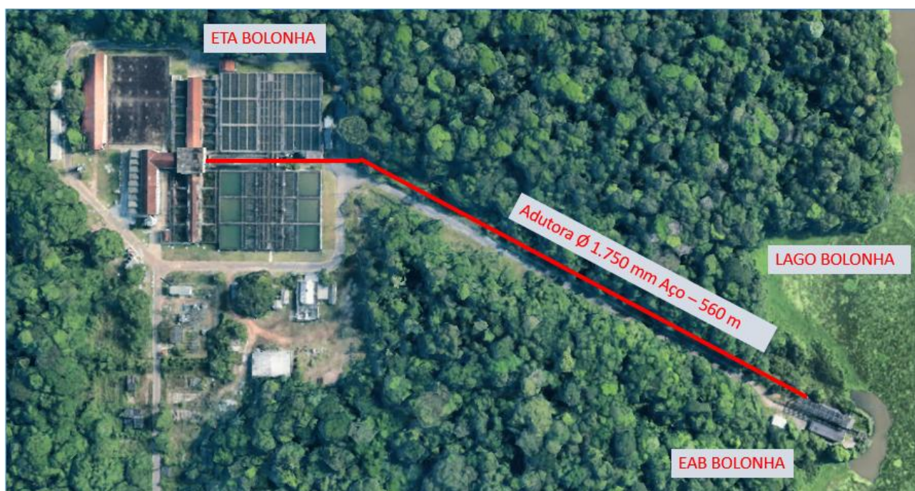
Figura 02 – Captação no Lago Bolonha para abastecimento da ETA Bolonha.
